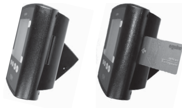
LECTOR DE TARJETA CHIP EN EL OPTIBIKE
